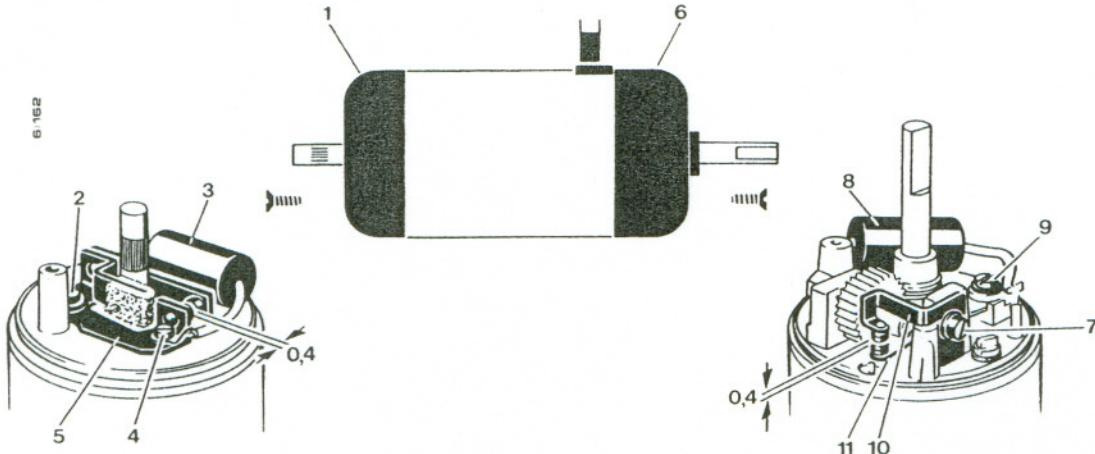
**Einstellen bzw. Austauschen des Unterbrecherkontakte für die Zündung.**
