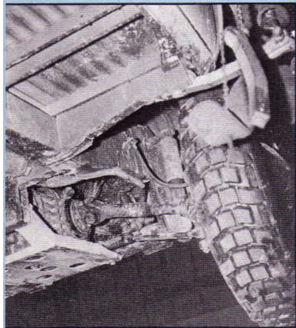
Oben: Der Allrad-Schalthebel rechts neben dem Fahrersitz, Warnleuchte für geöffnete Trennkupplung. — Links: Kegelradgetriebe und Antriebswellen der Vorderachse.
