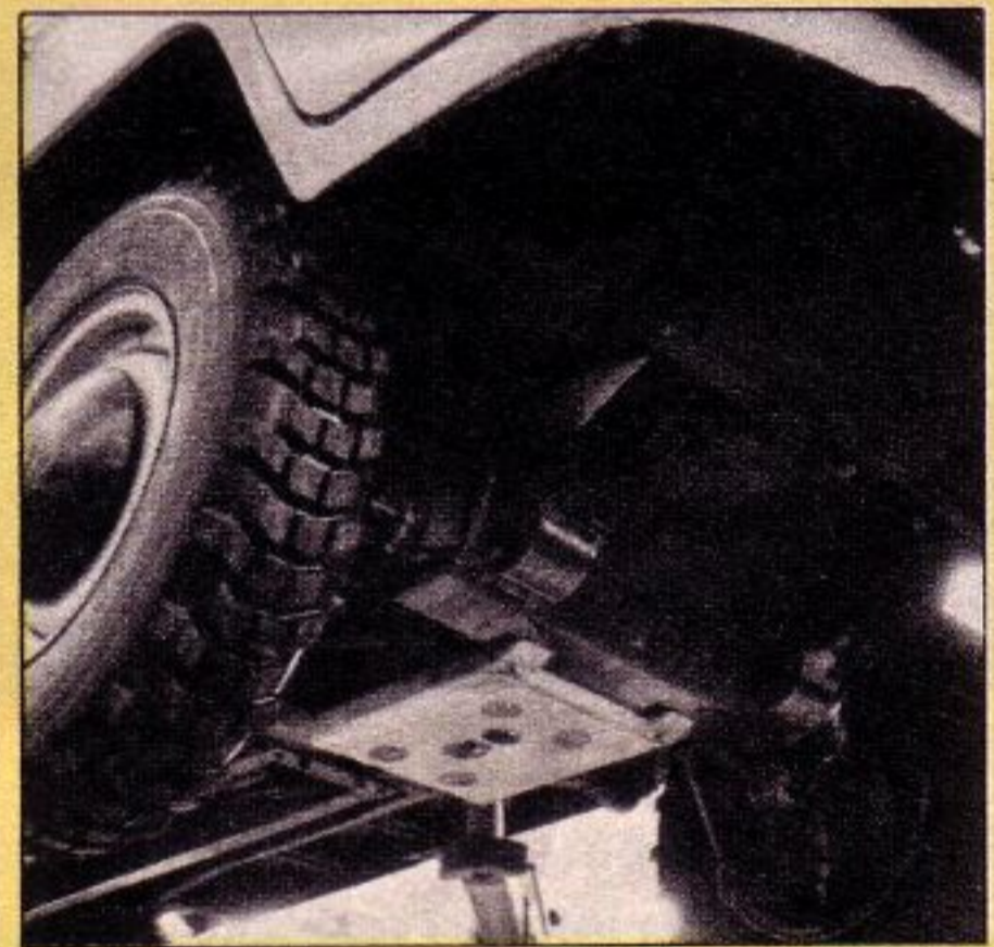
Abbremsung der Hinterräder und auf dem Armaturenbrett drei zusätzliche Kontrollinstrumente. Die Wagenunterseite ist komplett durch Bleche, Kufen und Leitern geschützt. Links: Vorderachse mit Antriebswelle zwischen den Längslenkern.
