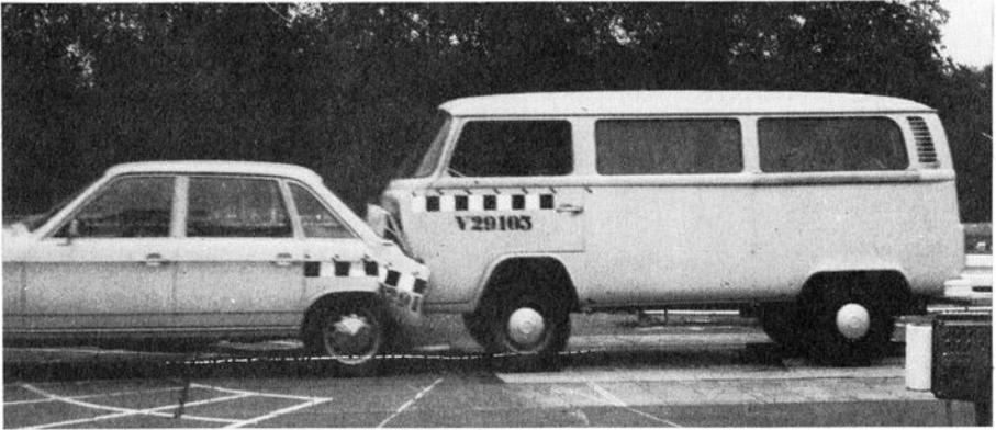
Das ist der Augenblick, da ein Transporter auf einen stehenden K-70 mit ca. 50 km/h aufprallt: das Pkw-Heck wird stark deformiert, d.h. geknautcht, während der Frontlenker auch, aber weniger spektakulär, Energie umwandelt.
