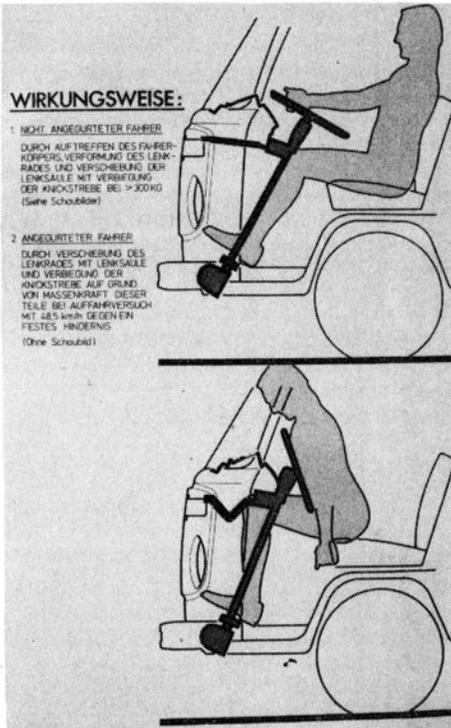
VW hat die relativ steil aufragende Lenksäule der Transporter durch eine sogen. Knickstrebe entschärft, die den oberen Abschnitt der Lenksäule mit der Wagenvorderwand verbindet. Die Knickstrebe gibt nach und verformt sich, d.h. sie nimmt durch Verformung Energie auf.
