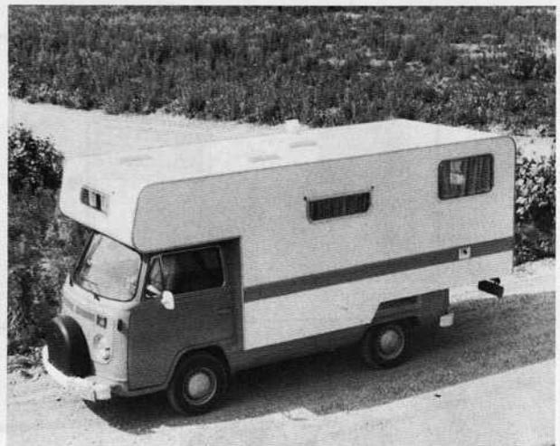
**Auf einen Stahlkäfig schweißte Bischofberger die Karosserie, deren Alkoven das Dach des Fahrerhauses ersetzt. Unten: Viel Platz im erhöhten Heck.**
