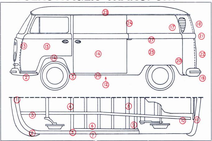
Bevor man mit der ML-Behandlung beginnt, entferne man die Türverkleidung, die Gummistopfen des inneren Schwellenträgers (6), demontiere eventuell vorhandene Verkleidungen im Laderaum und bohre die Löcher 14 im Vorderradbogen in einem Abstand von ca. 20 cm vom Türpfosten. Fahre den Wagen auf die Bühne und demontiere die Räder, auf jeder Seite eine der beiden Stoßstangenbolzen (2), die Spritzfangbleche vorne im Radkastenträger.
