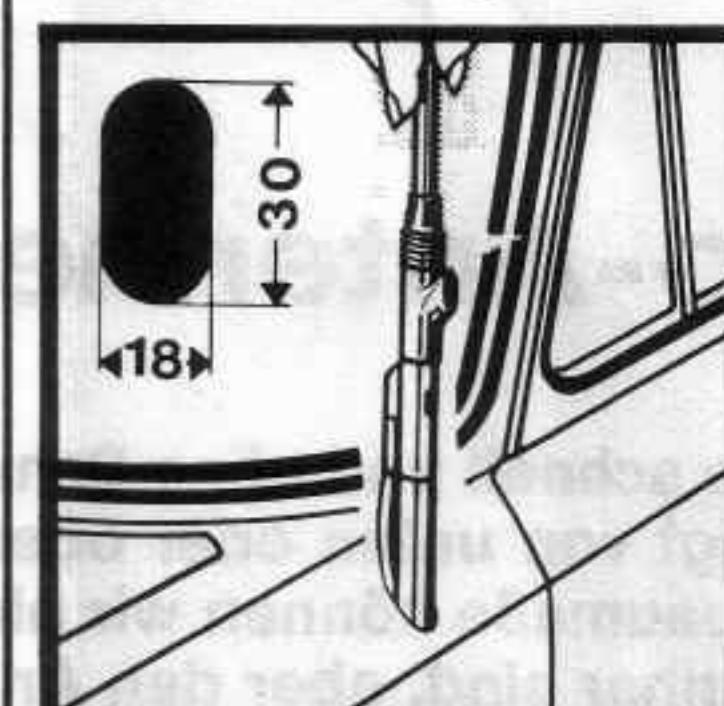
Die Antenne bei offenem Kotflügel mit dem Halter befestigen. Antenne von unten her in die Bohrung einsetzen. Dichtunterlage, Paßstück und Sechskantmutter auf die Antenne stecken. Mutter leicht anziehen. Die Antenne ausrichten.
