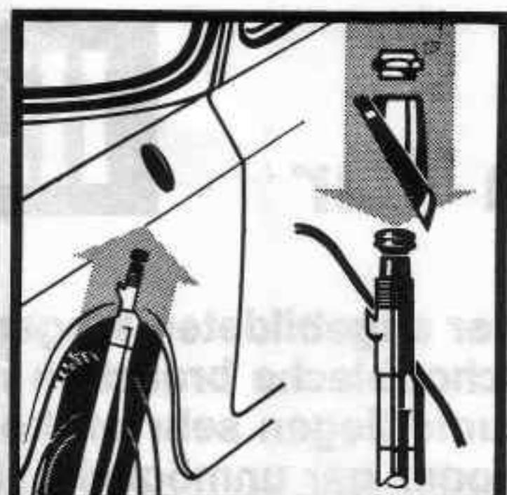
Bohrung in die Karosserie einarbeiten, bzw. vorhandene freilegen. Auf der Unterseite um die Bohrung herum blank machen und einfetten.
