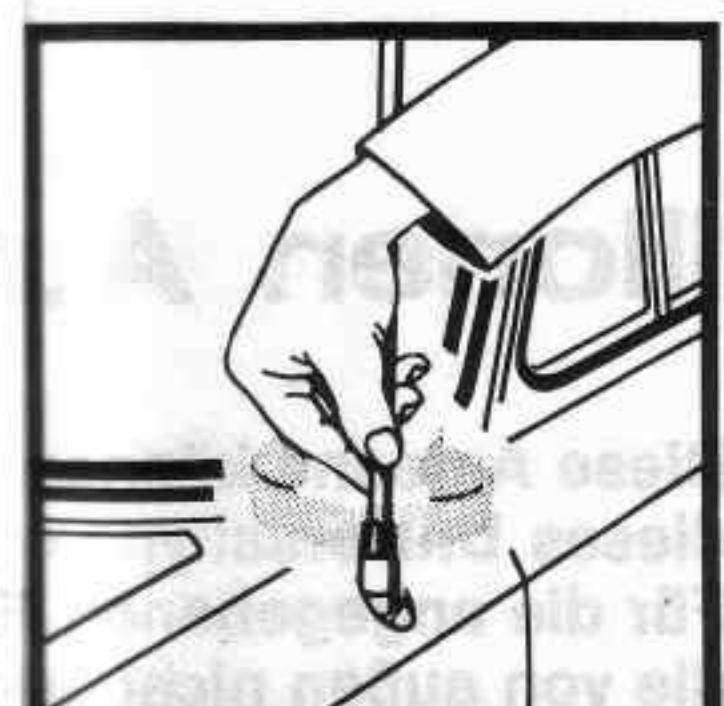
Zur Montage von außen muß die Bohrung an der Einbaustelle entsprechend eingearbeitet werden, dann das Teleskop ca. 20 cm ausziehen und zuerst das Kabel einführen.
