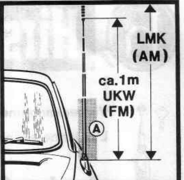
Unteres Rohr (7 mm  $\varnothing$ ) immer vollständig ausziehen (A). Günstigste Länge für UKW ca. 100 cm (obere Rohre einschieben), für LMK so lang wie möglich. Anhaftenden Schmutz abwischen. Zur Pflege empfehlen wir Autoantennenfett in Tuben – Auta 235.
