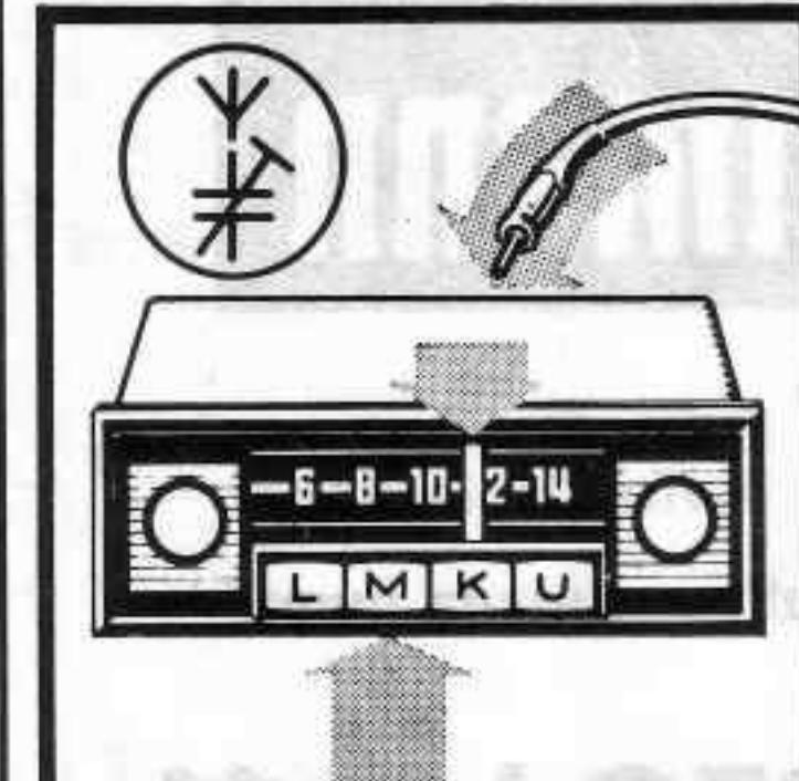
Den Antennenträmer am Empfänger abstimmen. Die Antenne ganz ausziehen, im MW-Bereich einen schwachen Sender einstellen und den Antennenträmer auf größte Lautstärke drehen (Anleitung des Geräteherstellers beachten).
